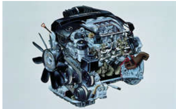
Verbrennungsmotor bei optimalem Arbeitspunkt \eta = 34\% - 50\%
